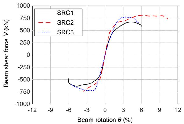
(d) Envelope curves of tested specimens
